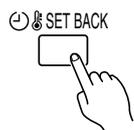
Для переключения между режимами отображения времени в формате 12 и 24 часов нажмите кнопку SET BACK (настройка таймера).
